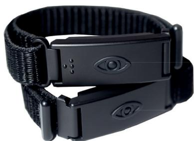
Solution de guidage GPS permettant d'être informé par bracelets vibrant s'il faut tourner à gauche, à droite, ou aller tout droit.
